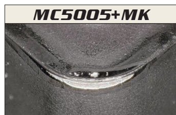
Zużycie ścierne 0,29 mm Po obróbce 30 sztuk
