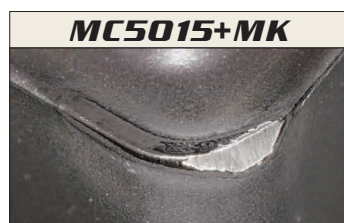
Wielkość zużycia: 0,44 mm Po obróbce 17 sztuk
